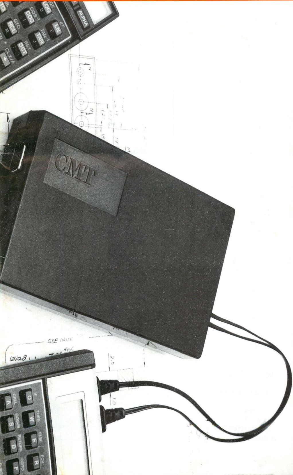
Die HP-IL RAM-Disk von CMT ist ein kleines und nützliches Gerät für unterwegs. Sie kann bis zu 512 KByte an Daten speichern. Auf Reisen ist diese somit ideal als Backup-Medium einzusetzen, damit unterwegs erfaßte Daten oder geschriebene Programme nicht durch "Memory Lost" unwiederbringlich verschwinden. Als Option gibt es auch eine RS232-Schnittstelle. Dann kann man auch von unterwegs mit einem zusätzlichen Modem in die ClubMailbox gelangen.
