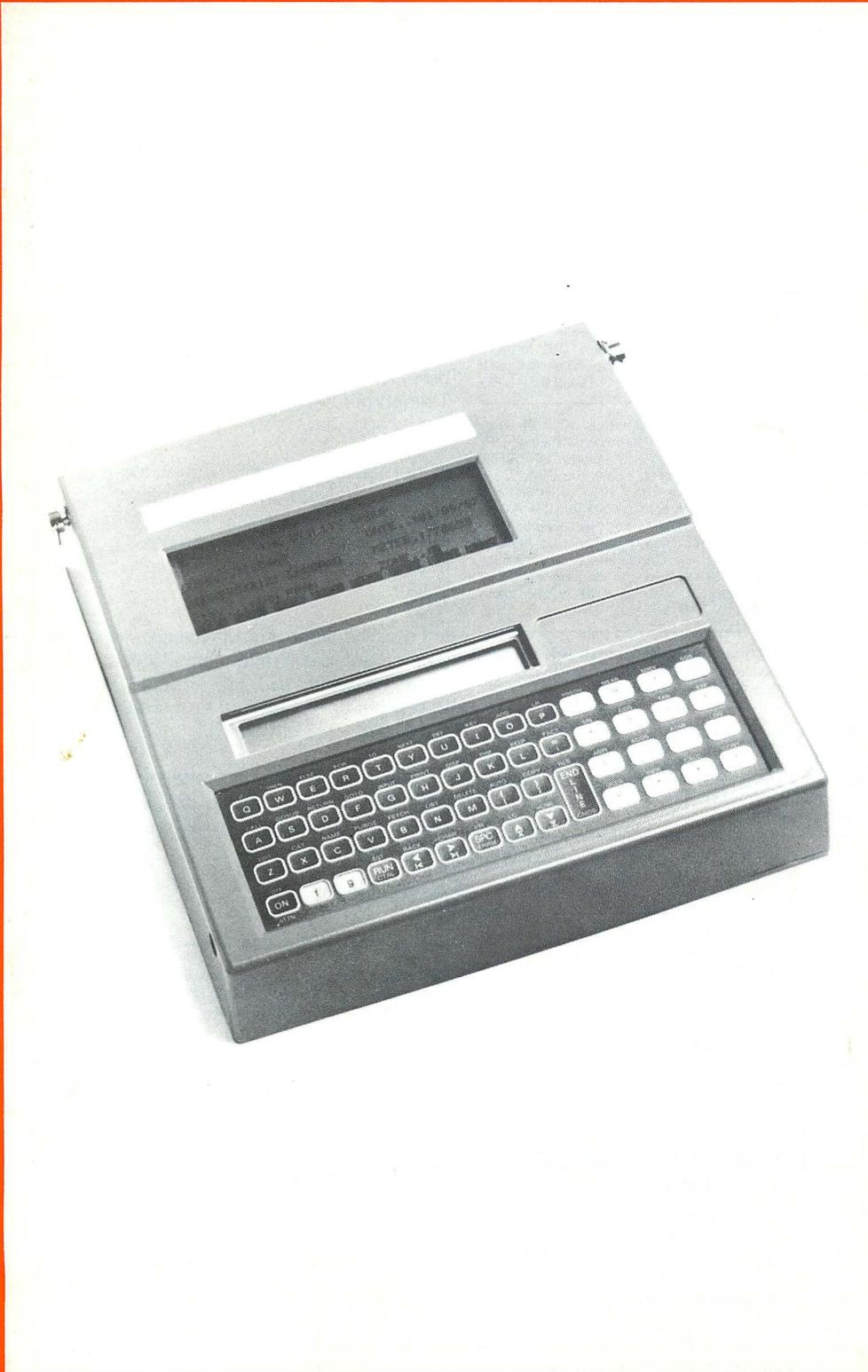
Das CMT-Multicase ist ein wasserfestes Schutzgehäuse aus Polykarbonat für den HP-71 mit integriertem 8-zeiligen LC-Display. Außerdem befinden sich in diesem Gehäuse auch 128 KByte RAM-Disk sowie eine HP-IL/RS-232C-Schnittstelle. Durch den eingebauten Heizwiderstand kann der HP-71 auch im rauen Außendienst-einsatz bei Minus-Graden verwendet werden.
